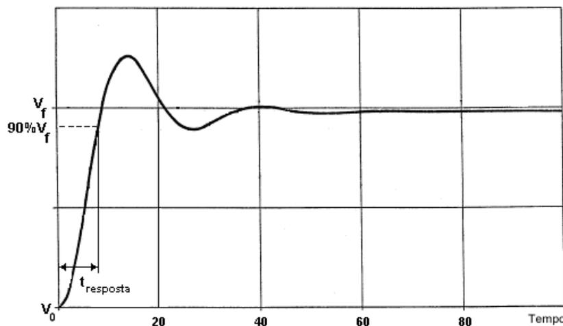
Figura 2 – Resposta esperada da ação do regulador
