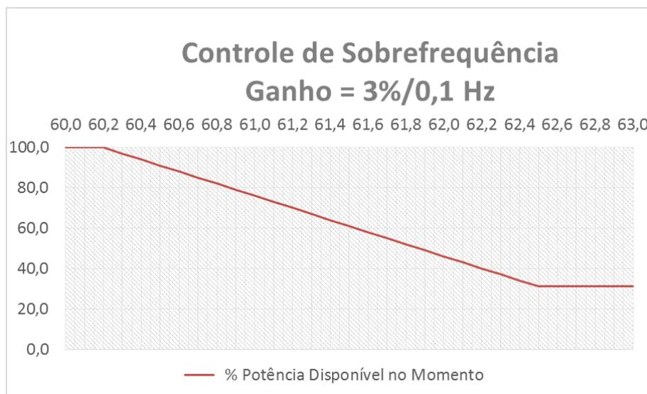
Figura 8 - Requisito para controle de sobrefrequência de aerogeradores
